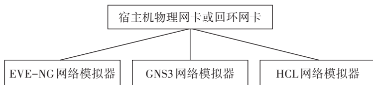
图1 EVE-NG、GNS3、HCL三款网络模拟器整合原理
