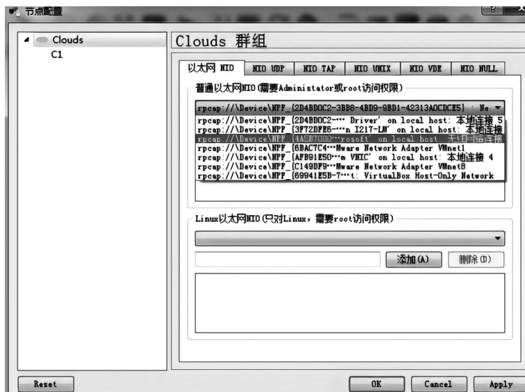
图4 GNS3中Cloud云节点配置
