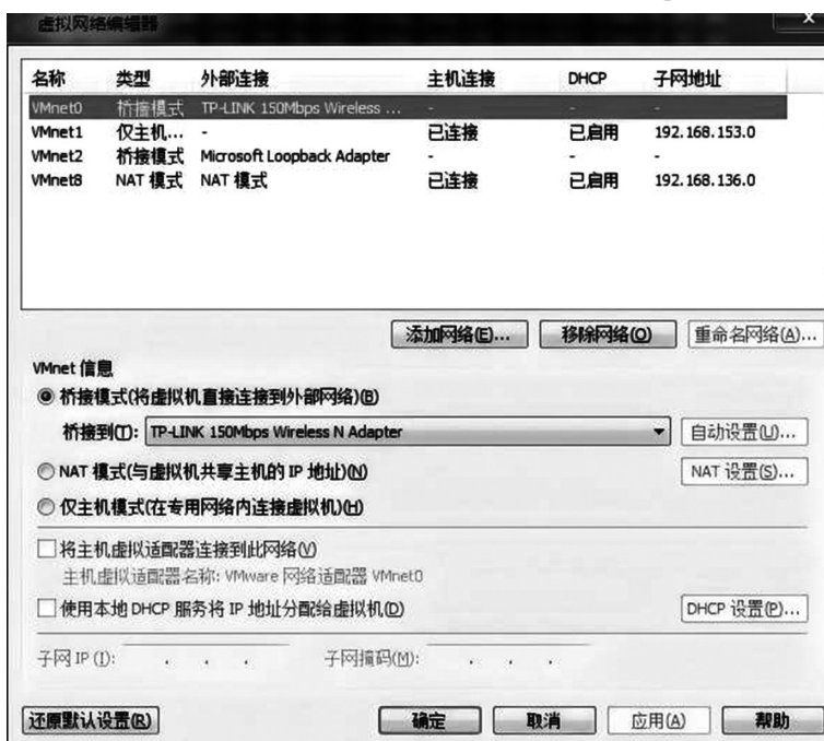
图2 对 VMnet0 虚拟网卡进行编辑
